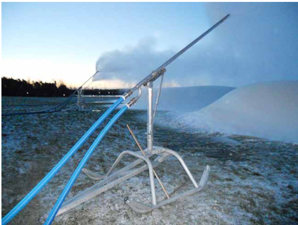
Kuva 5. Korkeapainelumitykki runkoineen sekä paine- ja vesiletkut.
